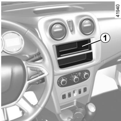
Se il vostro veicolo non è dotato di un sistema audio, disponete di una predisposizione composta da vani per:
