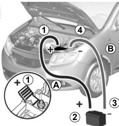
Fissate il cavo positivo (+) **A** sul morsetto (+) **1** della batteria scarica, quindi sul morsetto (+) **2** della batteria che fornisce la corrente.
