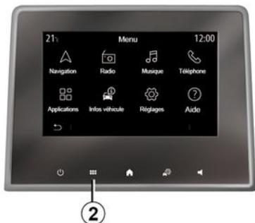
Um auf das Hauptmenü zuzugreifen, drücken Sie auf der Zentralsteuerung oder der Fernbedienung die Schaltfläche **2** auf dem Bildschirm.
