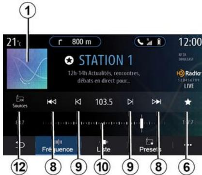
Wählen Sie diesen Modus, um Radiosender nach Frequenz im aktuellen Frequenzband auszuwählen. Um den Frequenzbereich zu durchsuchen, haben Sie zwei Möglichkeiten:
