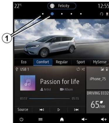
Diese Widgets ermöglichen es Ihnen, direkt auf die Hauptseite der Funktion zuzugreifen oder in bestimmten Fällen, sie direkt über eine der Hauptseiten zu steuern (z. B. Wechsel des Radiosenders).
