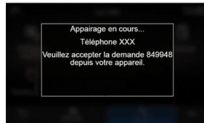
Im Bildschirm des Multimediasystems und auf dem Telefon wird eine Meldung angezeigt, die Sie auffordert, die Kopplungsanfrage mit dem angegebenen Code zu akzeptieren.
