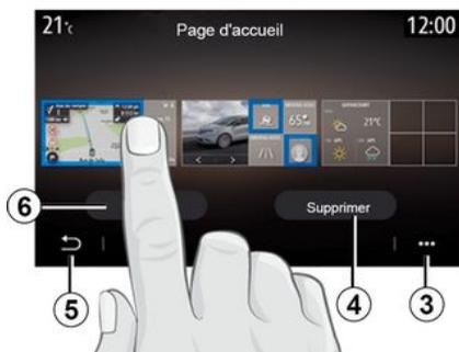
Im Querformat können Sie die vollständige Ansicht aller Ihrer Startseiten anzeigen lassen. Um Widgets aus dem Kontextmenü **3** zu löschen, drücken Sie die Schaltfläche „Löschen“ **4**.
