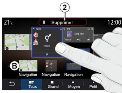
Halten Sie das Widget, das Sie löschen möchten, gedrückt. Es ändert die Farbe, um die Registrierung zu bestätigen. Ziehen Sie das Widget per Drag & Drop auf die Schaltfläche „Löschen“ **2** oder in den Bereich **B**.
