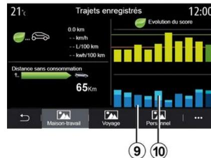
**9.** - в гибридном автомобиле мультимедийная система отображает средний расход топлива (темный цвет) отдельно от потребления энергии (светлый цвет) **10**.
