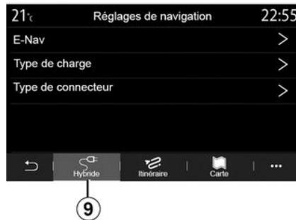
На вкладке "Гибрид" **9** можно задать настройки и предупреждения для гибридных автомобилей.
