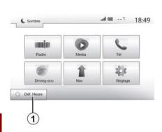
Cuando está instalada, esta función permite programar el motor para su arranque a distancia con el fin de calentar o ventilar el habitáculo hasta 24 horas antes de utilizar el vehículo.
