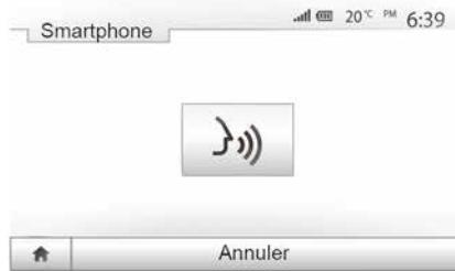
Звуковой сигнал и сообщение на экране **A** показывает, что система голосового управления включена.
