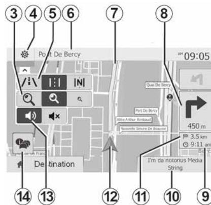
**4.** Опции отображения системы навигации.
