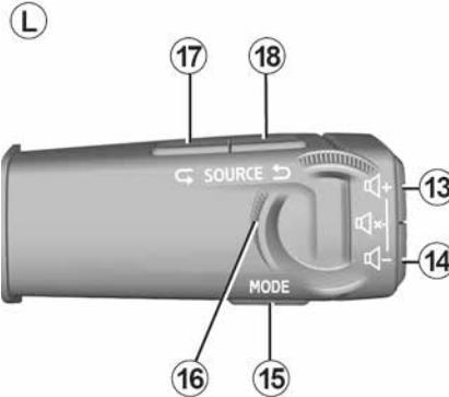
Кнопки керування радіосистемою під кермом
