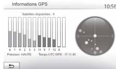
Ця функція дозволяє перевіряти стан супутників GPS.
