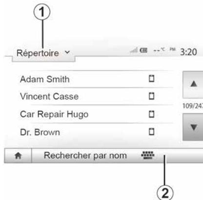
No menu "Telefone", prima 1 para percorrer a lista de menus e, em seguida, prima "Contact." para aceder à lista telefónica do sistema.
