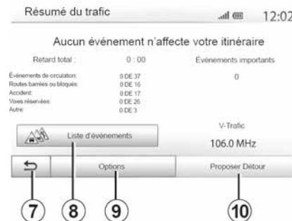
Ekranda yolunuz üzerinde farklı olayları gösterir. Sistem parkura eklenen bu olayları geçikme zamanı olarak size bildirecektir. Olay gösterim ayarlarını değiştirmek için **8** ögesine basın. Rotadan sapmak için **10** düğmesine, trafik seçeneklerine erişmek için **9** veya navigasyona dönmek için **7** düğmesine basın → **27**.
