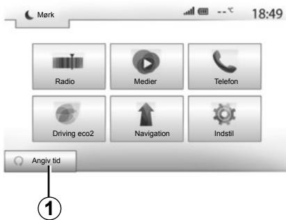
Med denne funktion kan du programmer motoren til at starte for at kunne opvarme eller udlufte kabinen op til 24 timer før brug af vognen.
