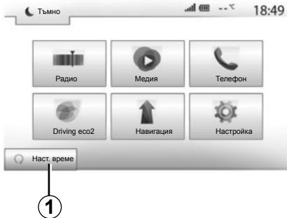
Ако е инсталирана, тази функция ви позволява също да програмирате двигателя да бъде стартиран дистанционно, за да се затопли или провери купето до 24 часа, преди да използвате автомобила. Регулирайте необходимото ниво на отопление (температура, размразяване), преди да програмирате функцията. Конфигурирането и програмирането се извършват през мултимедийния дисплей.
