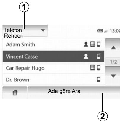
Listede gezinmek için "Telefon Rehberi" ve sonra sistemin telefon rehberine ulaşmak için **1** üzerine basın.
