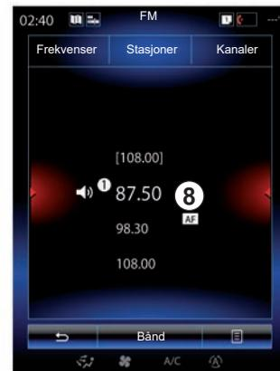
Hvis radiokanalen ikke støtter RDS-systemet, eller hvis kjøretøyet befinner seg i et område med dårlig dekning, blir ikke navnet på radiokanalen vist på skjermen. Kanalen blir vist bare med frekvens, og plassert øverst på listen.
