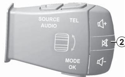
Du kan avbryte talesynthesizeren i talegjenkjenningssystemet ved å trykke inn **2**-knappen på rattstammekontrollen. Et lydsignal varsler at du kan snakke.
