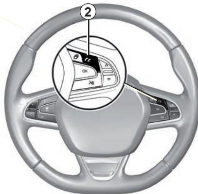
Du kan besvare/avslutte et anrop med et direkte trykk på kontroll **2** på rattet.
