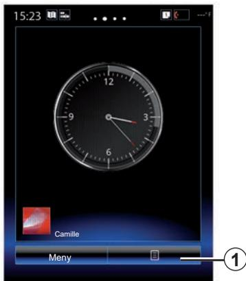
Startsidene er standardskjermbildene for multimediesystemet. Systemet har fire startsider (tre av dem kan tilpasses) samt kontrollprogrammer som fører til ulike funksjoner (f.eks. navigasjon og radio).
