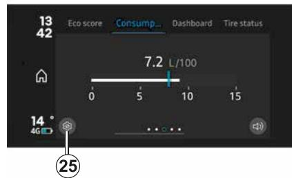
Die Funktion zeigt den aktuellen Kraftstoffverbrauch im Vergleich zum durchschnittlichen Kraftstoffverbrauch des Fahrzeugs an.
