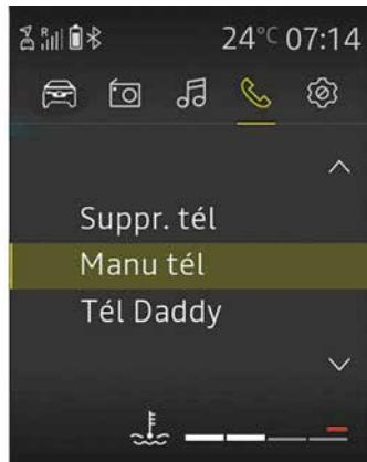
Durch die Entkopplung wird das Telefon aus dem Speicher des Audiosystems gelöscht.
