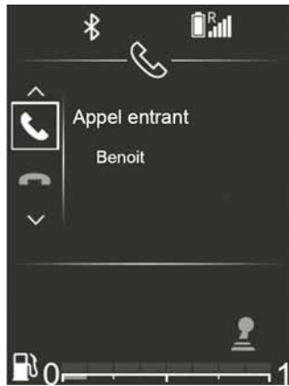
Wanneer een telefoongesprek binnenkomt, wordt het nummer van de beller op het scherm van het audiosysteem weergegeven (deze functie varieert af naar gelang de opties waarop u zich hebt geabonneerd bij uw telefoonserviceprovider).
