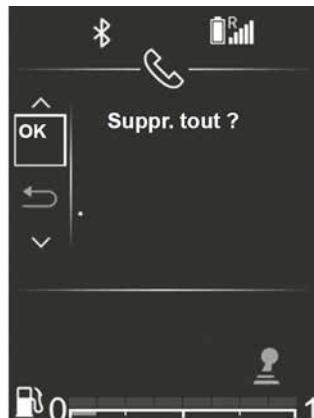
Alle telefoons ontkoppelen en verwijderen uit het geheugen van het audiosysteem:
