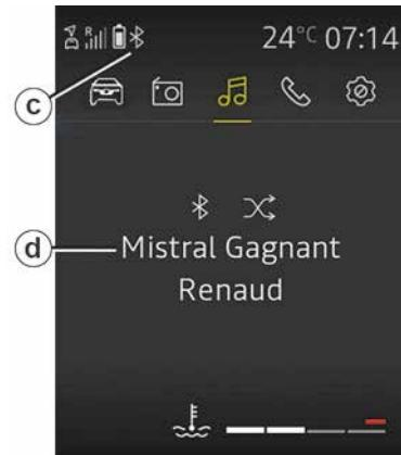
Una volta che il lettore audio digitale portatile Bluetooth® è connesso, potete controllarlo tramite il vostro sistema audio.
