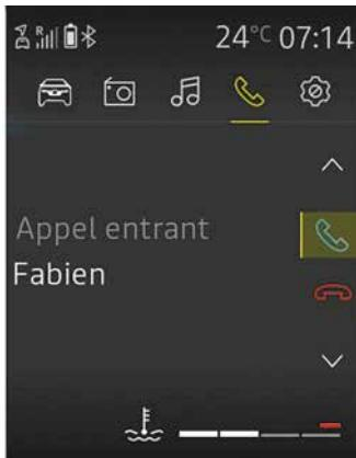
Wanneer een telefoongesprek binnenkomt, wordt het nummer van de beller op het scherm van het audiosysteem weergegeven (deze functie varieert al naar gelang de opties waarop u zich hebt geabonneerd bij uw telefoonserviceprovider).
