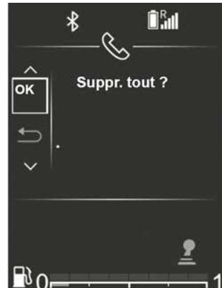
So entkoppeln und löschen Sie alle Telefone im Speicher des Audiosystems:
