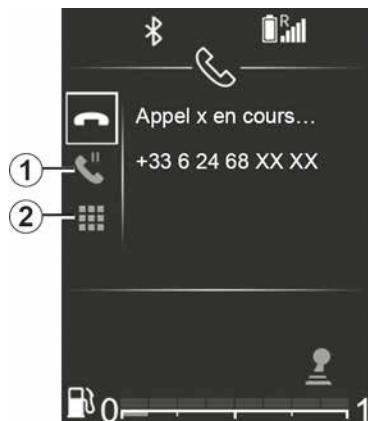
Quando si riceve una seconda chiamata, il numero del secondo chiamante viene visualizzato sullo schermo del sistema audio (questa funzione dipende dalle opzioni sottoscritte con il proprio operatore telefonico). È possibile:
