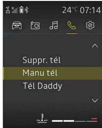
Door een telefoon te ontkoppelen, kan deze uit het geheugen van het audiosysteem worden verwijderd.
