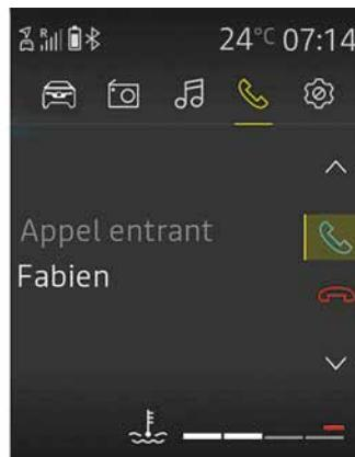
Quando si riceve una chiamata, il numero del chiamante viene visualizzato sullo schermo del sistema audio (questa funzione dipende dalle opzioni sottoscritte con il proprio operatore telefonico).
