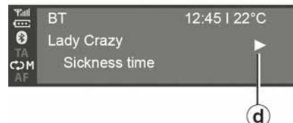
Zodra de externe audiobron wordt aangesloten, wordt de eerste audiotrack automatisch afgespeeld. Het symbool "PLAY" **d** wordt weergegeven.
