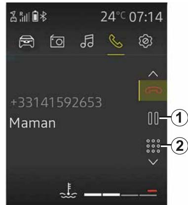
Wanneer een tweede telefoongesprek binnenkomt, wordt het nummer van de tweede beller op het scherm van het audiosysteem weer-
