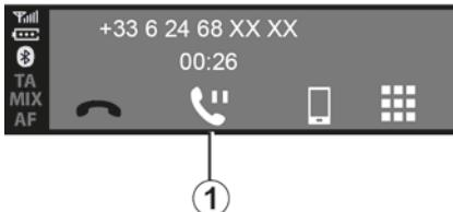
Da biste dolazni poziv stavili na čekanje, odaberite **1** pritiskom na na kontroli na upravljaču ili na ploči, a zatim pritisnite **OK** da biste potvrdili i stavili dolazni poziv na čekanje.
