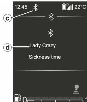
Nakon Bluetooth® spajanja prijenosnog digitalnog audio uređaja njime možete upravljati putem audio sustava.
