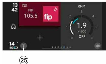
Din meniul de setări "R&Go", care poate fi accesat prin apăsarea butonului **25**, puteți accesa funcția de setări audio.
