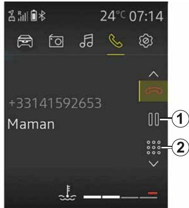
При приемане на второ обаждане номерът на обаждашния се показва на экрана на аудиосистемата (тази функция зависи от опциите, за които сте абонирани към телефонния оператор). Можете:
