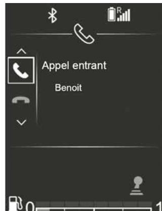
La recepționarea unui apel, numărul apelantului apare pe ecranul sistemului audio (această funcție depinde de opțiunile din abonamentul dvs. încheiat cu furnizorul de servicii de telefonia).
