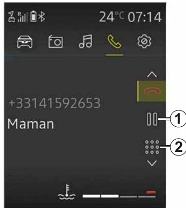
La recepționarea unui al doilea apel, numărul celu de al doilea apelant apare pe ecranul sistemului audio (această funcție depinde de opțiunile din abonamentul dvs. încheiat cu furnizorul de servicii de telefonia).
