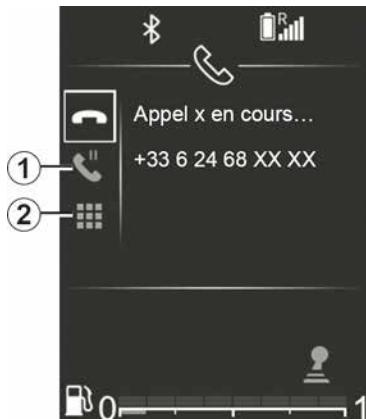
La recepționarea unui al doilea apel, numărul celui de al doilea apelant apare pe ecranul sistemului audio (această funcție depinde de opțiunile din abonamentul dvs. încheiat cu furnizorul de servicii de telefonie).
