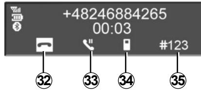
Gelen bir çağrıyı reddetmek için, ses sistemi ön panelindeki **10** düğmesine veya direksiyon simidi altındaki kumanda üzerinde bulunan **18**, **21** veya **27** öğesine veya direksiyondaki **29** öğesine uzun süre basınız. Gelen aramayı, ses sistemi ön panelindeki **5** veya direksiyon simidi altındaki kumanda üzerinde bulunan **20** topuzunu döndürmek ve topuza basmak yoluyla **32** simgesini seçerek de reddedebilirsiniz.
