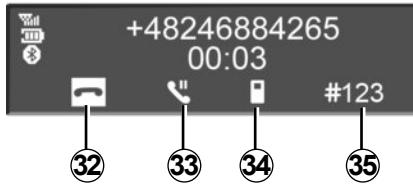
За да приемете входящо повикване, натиснете бутона **10** на предния панел на аудиосистемата или **18**, **21** или **27** на превключвателя на кормилната колона, или **29** на волана. Можете да приемете входящо повикване и като изберете иконата **32** чрез завъртане и натискане на регулатора **5** на предния панел на аудиосистемата или **20** на превключвателя на кормилната колона.
