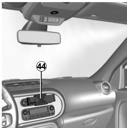
**Σημείωση:** μπορείτε να χρησιμοποιήσετε τη βάση τηλεφώνου **44** σε δύο θέσεις:
