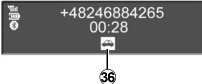
За да изберете желаната икона, завъртете регулатора **5** на предния панел на аудиосистемата или натиснете **20** на превключвателя на кормилната колона, след което потвърдете чрез натискане на регулатора **5** на предния панел на аудиосистемата или **20** на превключвателя на кормилната колона.
