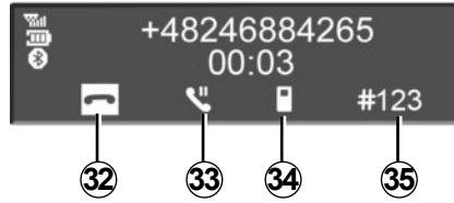
For å avvise et anrop holder du inne knappen **10** på lydsystemets frontpanel, eller **18**, **21** eller **27** på rattstammekontrollen eller **29** på rattet. Du kan også avvise et innkommende anrop ved å velge ikonet **32** ved å vri og trykke på kontrollknappen **5** på lydsystemets frontpanel eller **20** på rattstammekontrollen.
