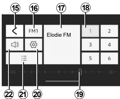
**19** Radiofrekvensbånd, radiofrekvens-informasjon
