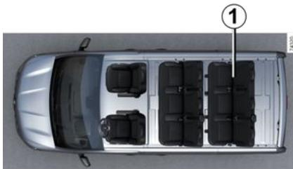
Avant l'installation d'un fauteuil roulant, il est nécessaire de déposer la banquette 1. Reportez-vous à la notice du véhicule.
