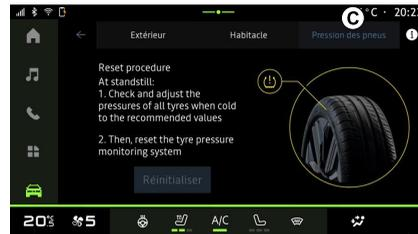
Utilizzare questo menu per controllare lo stato della pressione degli pneumatici del veicolo ed eseguire un reset.
