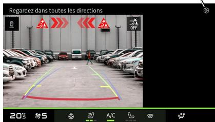
Quando si inserisce la retromarcia, la telecamera di retromarcia situata nella parte posteriore del veicolo viene attivata per trasmettere la vista dietro il veicolo allo schermo multimediale.
