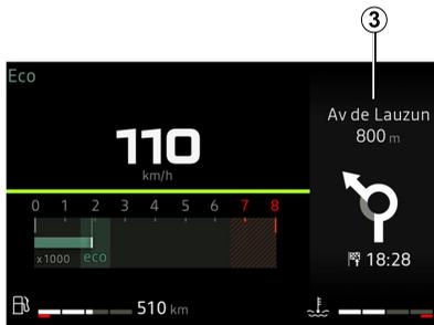
È possibile utilizzare la replica per visualizzare la navigazione sul quadro della strumentazione **3**.
