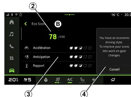
Dalla modalità di visualizzazione "Punteggio Eco" **B** è possibile visualizzare il comportamento di guida in termini di risparmio energetico dalla partenza per il viaggio in corso.
