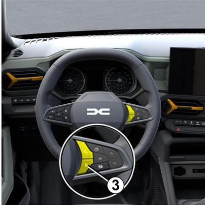
Tenere premuto il comando **3** per attivare/disattivare la funzione di riconoscimento vocale dello smartphone per il controllo di determinate app e funzioni tramite un comando vocale.
