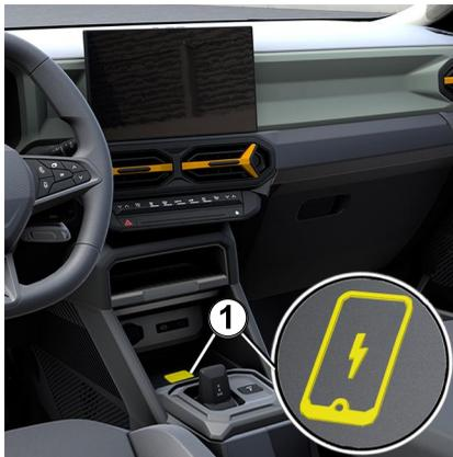
L'area di ricarica a induzione **1** può essere utilizzata per caricare un telefono senza collegarlo a un cavo.
