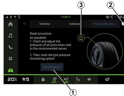
Dal sistema multimediale è possibile controllare lo stato della pressione dei pneumatici.
