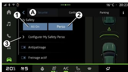
Mediante la scheda "Sicurezza" **A**, è possibile attivare/disattivare e/o configurare ausili alla guida relativi alla sicurezza:
