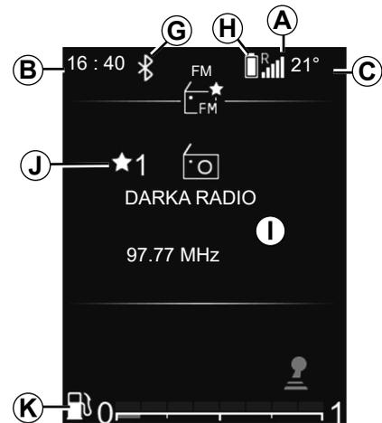
Radio med display på instrumentpanelen
