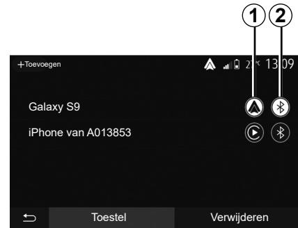
**Opmerkingen:** markeert 1 en 2 in het menu "Inst" > "Toestellen" vervolgens geeft "Toestel Manager" aan dat uw smartphone is gekoppeld en is verbonden met uw multimediasysteem. Dit is nodig om spraakherkenning te gebruiken.
