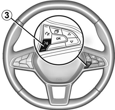
Sobald die Anwendung „Android Auto™“ oder der Dienst „CarPlay™“ aktiviert wurde, können Sie über die Spracherkennungstaste des Fahrzeugs bestimmte Smartphone-Funktionen mittels Sprachbefehlen aktivieren. Zu diesem Zweck drücken Sie die Taste **3** am Lenkrad des Fahrzeugs (weitere Informationen finden Sie im Abschnitt „Verwendung der Spracherkennung“).
