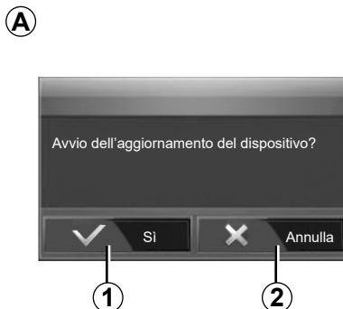
La schermata **A** viene visualizzata automaticamente una volta collegata la chiavetta USB:
