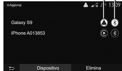
**Nota:** i riferimenti **1** e **2** nel menu «Impost» > «Dispositivi» e successivamente «Gestione dispositivi» indicano che lo smartphone è abbinato e collegato al sistema multimediale. Questa operazione è necessaria per poter utilizzare il riconoscimento vocale.
