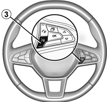
Una volta attivata l'applicazione «Android Auto™» o il servizio «CarPlay™», potete utilizzare il pulsante di riconoscimento vocale del veicolo per attivare alcune funzioni dello smartphone. A tal fine, premete il pulsante 3 sul volante del veicolo (per ulteriori dettagli, consultate il capitolo «Utilizzare il riconoscimento vocale»).
