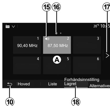
Navnene på radiokanalene som ikke bruker RDS, vises ikke på skjermen. Bare frekvensene vises og de sorteres på slutten av listen.
