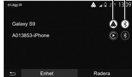
**Obs!** markerar **1** och **2** i "Inställning"-menyn > "Enheter" sedan "Enhetshanteraren" indikerar att din smartphone är parat och ansluten till ditt multimediasystem. Detta är nödvändigt för att använda röstigenkänning.
