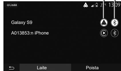
**Huomautus:** merkit **1** ja **2** "Asetus"-valikossa > "Laitteet" "Laitehallinta" ilmai-sevat, että älypuhelin on yhdistetty multi-me-diajärjestelmään. Tämä on tarpeen, jotta puheentunnistus on käytettävissä.
