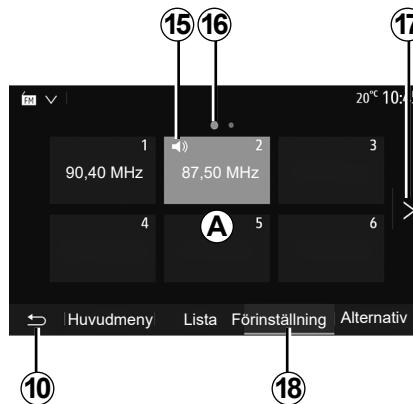
Namnen på radiostationer vars frekvens inte används av systemet RDS visas inte på skärmen. Endast deras frekvens visas och klassificeras i slutet av listan.
