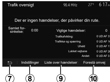
Skærmen viser de forskellige hændelser på din rute. Systemet vil oplyse dig om forsinkelserne på din rute som følge af disse uheld. Tryk på **8** for at ændre parametrene for visning af hændelser. Tryk på **10** for at køre en omvej, på **9** for at åbne trafikvalg (se kapitlet "Navigationsindstillinger") eller på **7** for at vende tilbage til navigationen.
