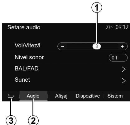
Din meniul principal, apăsați pe „Setare” pentru a afișa meniul de setări. Apăsați pe **2** pentru a accesa parametrii de sunet.
