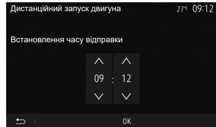
Якщо автомобіль оснащено цією функцією, можна запрограмувати дистанційний запуск двигуна, щоб заздалегідь (шонайбільше за 24 години) прогріти чи провітрити салон.
