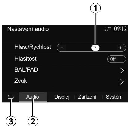
V hlavním menu stiskněte „Nastavení“ a získejte přístup k menu nastavení. Stiskněte 2 pro přístup k parametrům zvuku.
