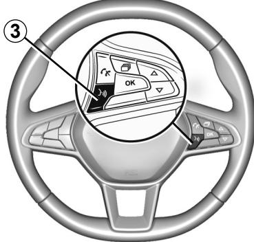
Po aktivácii aplikácie „Android Auto™“ alebo služby „CarPlay™“ môžete využívať tlačidlo hlasového rozpoznávania vo vozidle na hlasové aktivovanie niektorých funkcií smartfónu. Ak to chcete vykonať, stlačte tlačidlo **3** na volante vozidla (ďalšie informácie nájdete v časti „Používanie hlasového rozpoznávania“).
