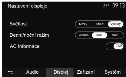
Chcete-li získat přístup k nastavení multimedialního systému ze zahajovací obrazovky, stiskněte „Nastavení“, a potom vyberte příslušnou sekci ve spodní části obrazovky.
