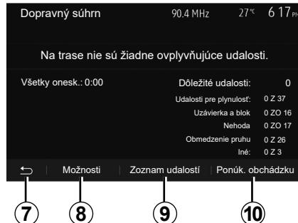
Na obrazovke sa zobrazujú rôzne udalosti, ktoré sa vyskytli na vašej trase. Systém zobrazuje dĺžku omeškania, ktoré tieto nehody pridajú k času vašej cesty. Stlačením tlačidla **8** zmeníte parametre zobrazenia udalostí. Stlačením tlačidla **10** vyberiete obchádzku, pomocou tlačidla **9** zobražíte možnosti dopravy (pozrite v kapitole „Nastavenia navigácie“) alebo stlačením tlačidla **7** sa vráťte na navigáciu.
