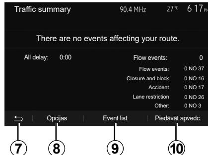
Ekrānā parādās dažādi notikumi izvēlētajā maršrutā. Sistēma norāda, par cik ilgu laiku šie notikumi pagarinā paredzamo braucienā laiku. Lai mainītu notikumu rādījumu parametrus, nospiediet **8**. Lai brauktu pa apkārtceļu, nospiediet **10**; lai piekļūtu satiksmes izvēles iespējām, nospiediet **9** (skatiet nodalju "Navigācijas sistēmas iestatījumi"); lai atgrieztos navigācijas ekrānā, nospiediet **7**.
