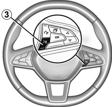
После активации приложения Android Auto™ или сервиса CarPlay™ для голосового управления некоторыми функциями подключенного смартфона можно использовать соответствующую кнопку в автомобиле. Для этого нажмите на кнопку **3** на рулевом колесе автомобиля (дополнительные сведения см. в разделе «Использование системы голосового управления»).
