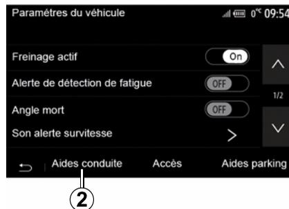
W zależności od pojazdu w tym menu można włączać/wyłączać systemy wspomagające prowadzenie pojazdu.
