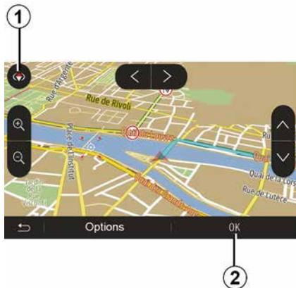
Po wprowadzeniu punktu docelowego nacisnąć przycisk **2** lub odczekać 10 sekund. Następuje włączenie funkcji naprowadzania.
