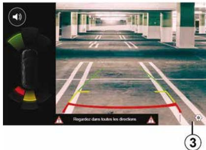
soante o veículo) que indicam a distância por trás do veículo e configurar as definições do ecrã.
