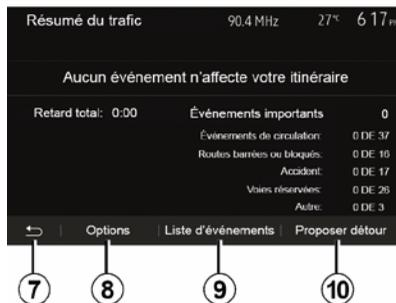
La pantalla indica las diferentes incidencias que afectan a su recorrido. El sistema le indicará el tiempo de retraso que estos incidentes añaden a su recorrido. Pulse **8** para modificar los parámetros de visualización de las incidencias. Pulse **10** para tomar un desvío, **9** para acceder a las opciones del tráfico (consulte el capítulo "Ajustes de navegación") o **7** para volver a la navegación.
