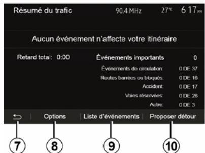
Ekran pokazuje różne zdarzenia występujące na trasie przejazdu. System pokazuje czas opóźnienia spowodowanego tymi zdarzeniami. Aby zmienić parametry wyświetlania zdarzeń, nacisnąć **8**. Nacisnąć przycisk **10**, aby wybrać objazd i przycisk **9**, aby wyświetlić opcje ruchu drogowego (patrz rozdział "Ustawienia systemu nawigacji") lub przycisk **7**, aby wrócić do nawigacji.
