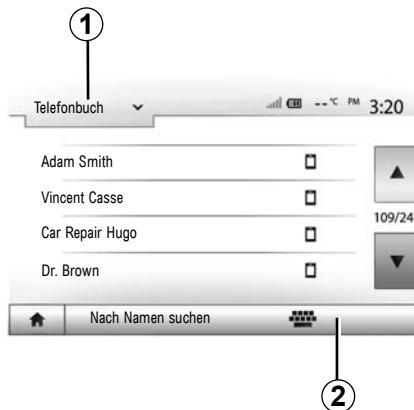
Drücken Sie im Menü „Telefon“ auf **1**, um die Liste der Menüs durchlaufen zu lassen und drücken Sie anschließend auf „Telefonbuch“, um auf das Telefonbuch des Systems zuzugreifen.
