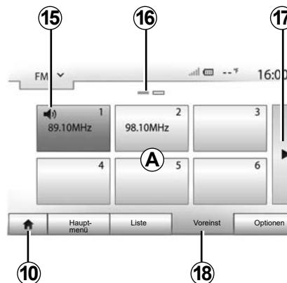
Die Namen der Sender, die keine RDS-Frequenz nutzen, erscheinen nicht im Display. Hier wird nur die Frequenz angezeigt. Diese Sender finden Sie am Listenende.
