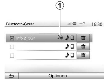
**Hinweis:** Das Symbol 1 im Menü „Einstellungen“ > „Verbindungen“ > „Liste der Bluetooth-Geräte anzeigen“ zeigt an, dass die Spracherkennung des Smartphones mit dem Multimediasystem kompatibel ist.
