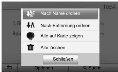
Um alle bevorzugten Zielorte zu löschen, drücken Sie auf „Optionen“ und anschließend auf „Alle löschen“. Bestätigen Sie das Löschen, indem Sie auf „Alle löschen“ drücken.
