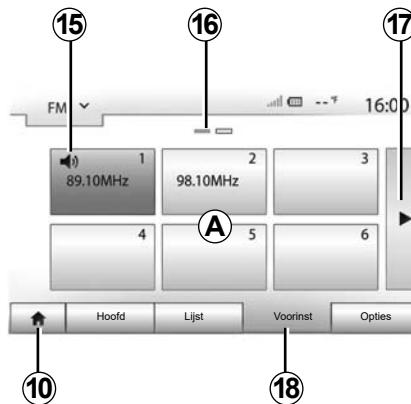
De namen van de radiostations die niet het RDS-systeem gebruiken, worden niet op het scherm weergegeven. Alleen hun frequentie wordt onderaan de lijst aangegeven.
