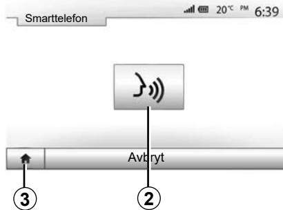
En pipetone høres, og displayet på skjerm **A** viser at talegjenkjenning er aktivert.
