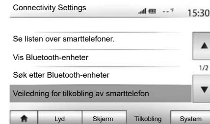
Du kommer til veiledning for tilkobling av smarttelefon til multimediesystemet via "Innst" > "Connectivity Settings".
