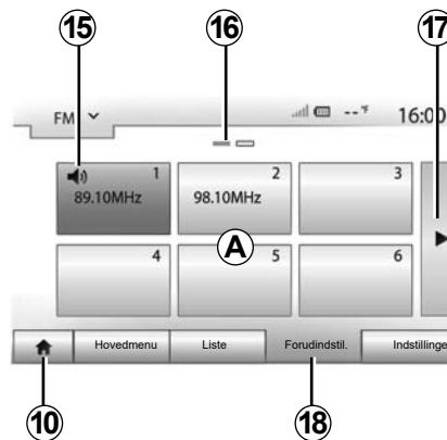
Navnene på de radiostationer, hvor frekvensen ikke bruger RDS-systemet, vises ikke på skærmen. Kun deres frekvens er angivet og sorteret i slutningen af listen.
