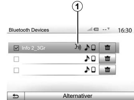
**Merk:** Merket 1 på menyen "Innst" > "Tilkobling" og "Vis liste over Bluetooth-enheter" betyr at talegjenkjenningssystemet på smarttelefonen din er kompatibelt med multimediesystemet.
