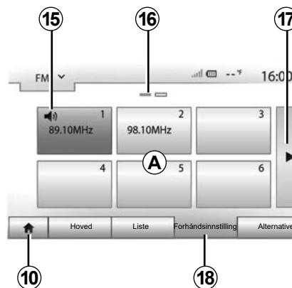
Navnene på radiokanalene som ikke bruker RDS, vises ikke på skjermen. Bare frekvensene vises og de sorteres på slutten av listen.
