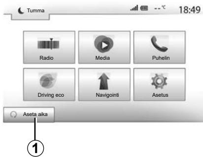
Jos autossa on tämä toiminto, voit ohjelmoida moottorin käynnistymisen matkustamon lämmitystä tai jäähdytystä varten aikaisintaan 24 tuntia ennen auton käyttöä. Säädää haluttu lämmityksen taso (lämpötila, huurteen- ja jäänpoisto), ennen kuin ohjelmoit toiminnon. Asetusten määrittäminen ja ohjelmointi tehdään multimedianäytössä.
