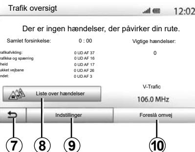
Skærmen viser de forskellige hændelser på din rute. Systemet vil oplyse dig om forsinkelserne på din rute som følge af disse uheld. Tryk på 8 for at ændre parametrene for visning af hændelser. Tryk på 10 for at køre en omvej, på 9 for at åbne trafikvalg (se kapitlet "Navigationsindstillinger") eller på 7 for at vende tilbage til navigationen.
