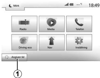
När den här funktionen är installerad kan du programmera fjärrstart av motorn för att värma upp eller ventilera kupén upp till 24 timmar innan du ska använda bilen.
