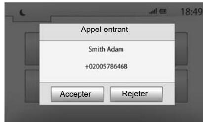
**Nota :** vous pouvez décrocher ou refuser un appel entrant en appuyant sur le bouton de la commande sous volant de votre véhicule.
