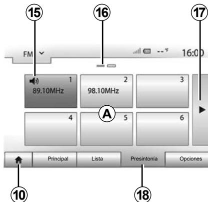
Los nombres de las emisoras de radio, cuya frecuencia no utiliza el sistema RDS, no aparecen en la pantalla. Solo su frecuencia está indicada y clasificada al final de la lista.
