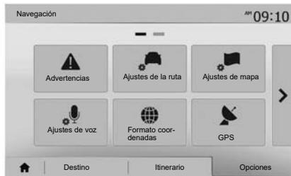
La pestaña «Opciones» en la parte inferior del menú «Navegación» permite cambiar la visualización del mapa o los parámetros de navegación.
