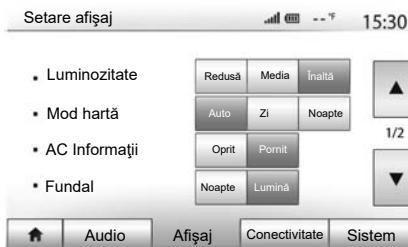
Pentru a accesa parametrii de reglare a sistemului multimedia, de pe ecranul de porneire, apăsați pe „Setări”, apoi selectați o rubrică din partea de jos a ecranului.
