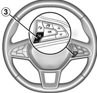
Μόλις ενεργοποιηθεί η εφαρμογή «Android Auto™» ή η υπηρεσία «CarPlay™», μπορείτε να χρησιμοποιήσετε το πλήκτρο φωνητικής αναγνώρισης στο αυτοκίνητό σας για να ενεργοποιήσετε ορισμένες φωνητικές λειτουργίες του smartphone σας. Για τον σκοπό αυτό, πιέστε το πλήκτρο **3** στο τιμόνι του αυτοκινήτου σας (για περισσότερες πληροφορίες, συμβουλευθείτε το κεφάλαιο «Χρήση φωνητικής αναγνώρισης»).
