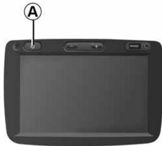
Sistemul multimedia intră în funcțiune automat la punerea contactului. În orice alte situații, apăsați pe tasta **A** pentru a porni sistemul dumneavoastră multimedia.
